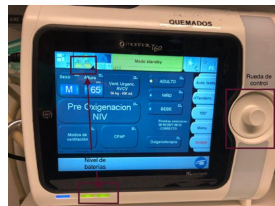
Figura 10: Pilotos indicadores de nivel de baterías y rueda de control.
